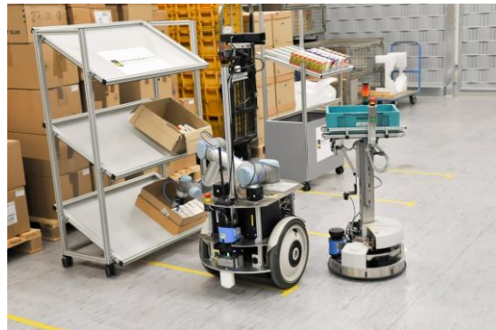
Abbildung 2: Flexible Kommissionierung mit einer heterogenen Roboterflotte in einem industriellen Umfeld ( https://www.youtube.be/cggCY-cvdJ8 ), Bildquelle: Service Robotics Research Center – Hochschule Ulm
