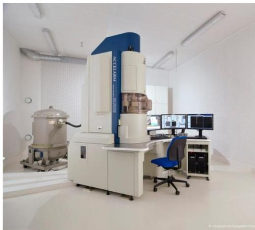
Abbildung 1: Hochauflösendes, analytisches Transmissionselektronenmikroskop (HRTEM) im neuen RegioWIN Campus, Bildquelle: Christoph Alt Fotografie Fulda
