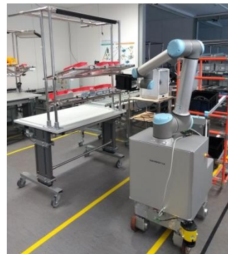
Kollaborativer Routenzug 4.0 – Demonstrator im Laborumfeld, Bildquelle: ESB-Logistikfabrik – Hochschule Reutlingen
