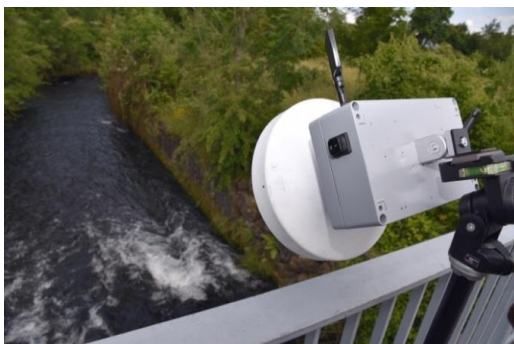
Abbildung 1: Rückstreuung von elektromagnetischen Wellen an rauen Oberflächen, Bildautor: Philipp Niemöller, Hochschule Ulm
