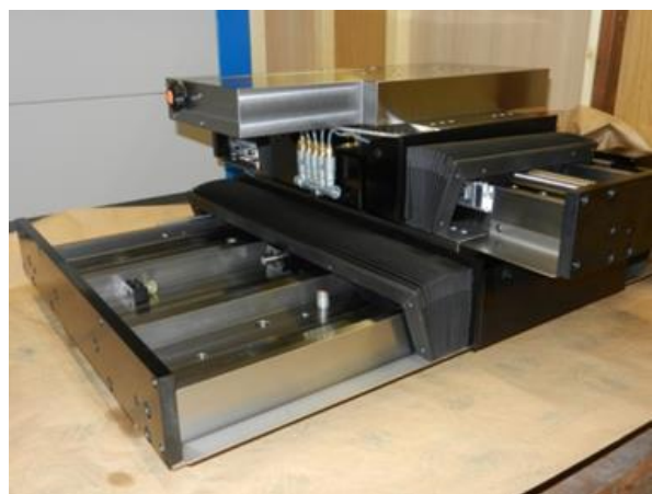
Abbildung 6: Beispiel eines Linearportals der ERO-Führungen GmbH Erich Rothweiler & Söhne, Bildquelle: Christina Mors
